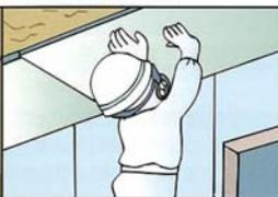
吹付けアスベスト等の層を残したまま、板状材料等で覆うことで、粉じんの飛散や損傷防止を図る工法。除去工法より安価ですが、建物の取壊し時には、除去工法が必要になります。
